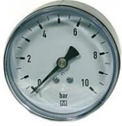
AFRISO Rohrfedermanometer RF 63 0/10bar G1/4B m.PTFE ax Kl.2,5
