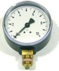
AFRISO Rohrfedermanometer RF 63 0/10bar G1/4B m.PTFE rad Kl.2,5
